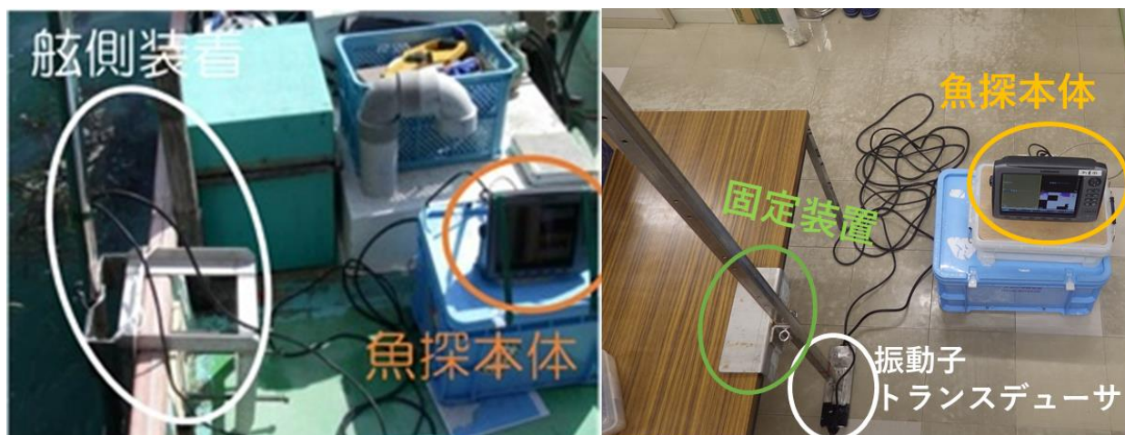
図 6-(3)-2. 簡易音響測器（魚群探知機）の船上での設置の様子と各種の名称
