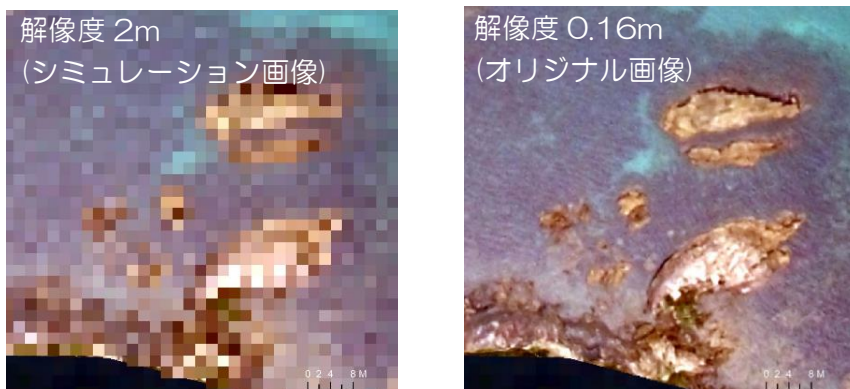
図 1-17 人工衛星 (World-View2) とドローン画像の解像度の比較
