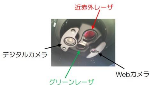
図 5-(6)-1. (a)ALB 機器の写真と (b) ALB の計測の仕組み
