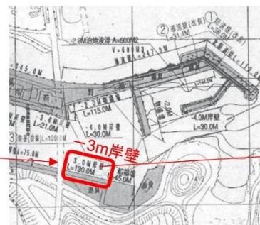
暫定係留施設(-3m岸壁)
