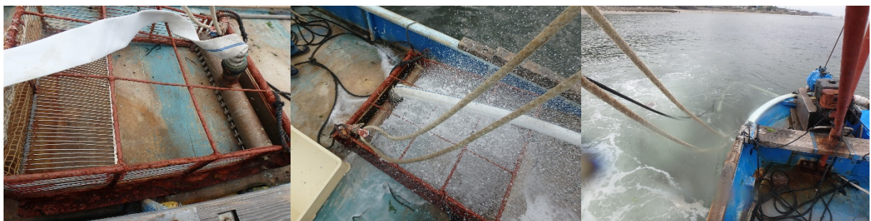
図3.2.3.1-1 試験に用いた漁具(左)とポンプ稼働時の水流噴射(中)、および曳航試験時の様子(右)
