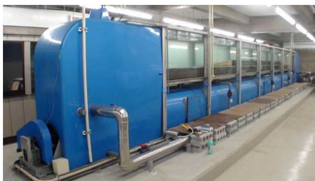
写真 2.2-1 振動流水槽(水産工学研究所保有)
