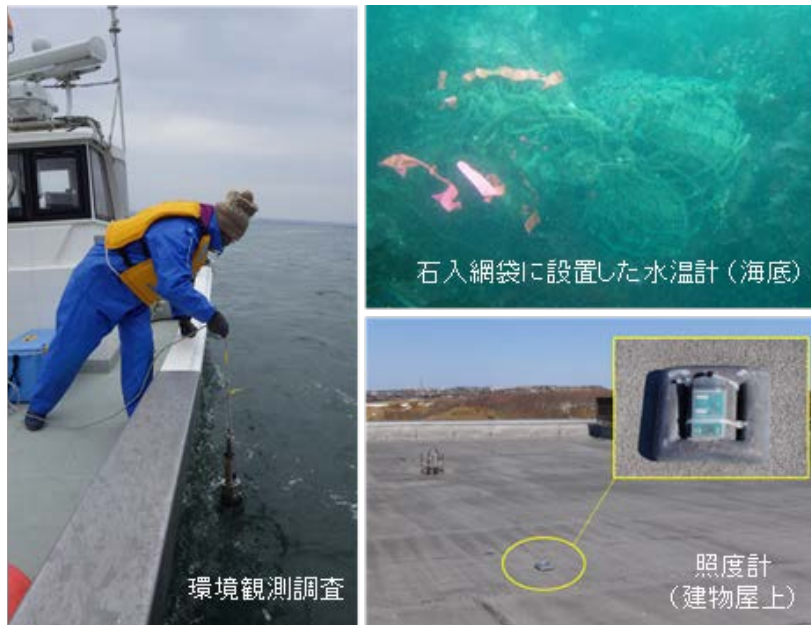
図 2-2-3. 現場観測、設置した水温計、照度計
