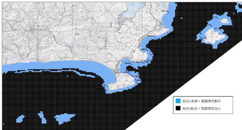
図ウ-15. 落石地区コンブ漁業操業区域の水深分布図。色分けはナガコンブ漁場の成立環境条件ならびにナガコンブの高生育・低生育環境条件閾値にもとづいて行った。水色はナガコンブ漁場として水深適性のあるメッシュ、黒は水深が深すぎるため水深適性のないメッシュ。
