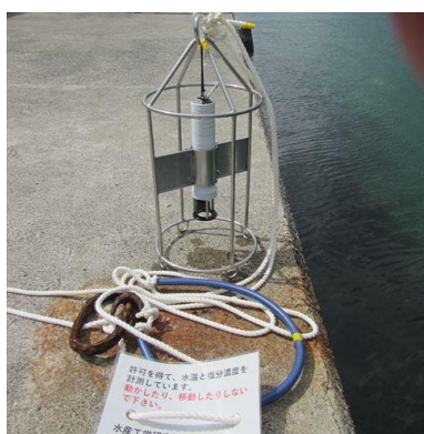
図 d-1-3-2-2 小浦漁港水域の水温等計測方法
