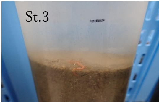
図 d-1-3-2-6 採取した底質コア（底質表面拡大）
