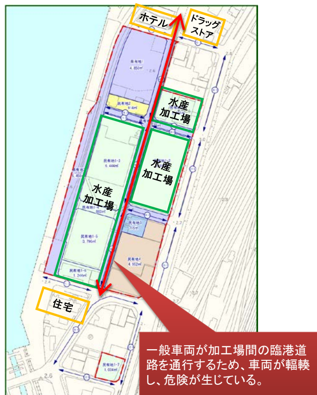
図 1-29 ウ漁港における施設の点在・用途の混在により課題が生じている例
