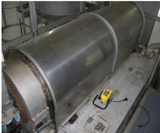
写真 2-15 汚泥処理装置
