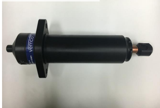
写真 3.2-10 切離し装置付き受信機
