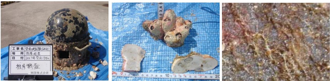
図 3-5-2 採取状況(左: 採取後、中: フジツボ、右: 多毛類と思われる全面付着生物)
