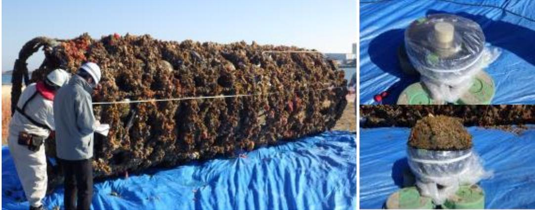
(左：回収された中層浮魚礁、右上：流出警報発信機、右下：付着物付試験機)
