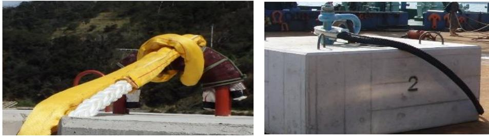
図3-2 シンカー直上の下部主係留索の補強対策
