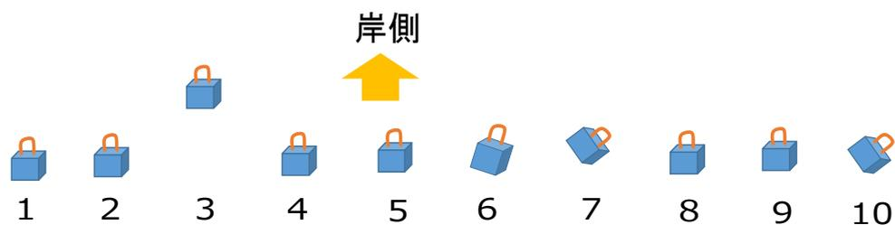
※2017 年台風 18 号（9/18 通過）により No. 3 が岸側に約 2m 移動
