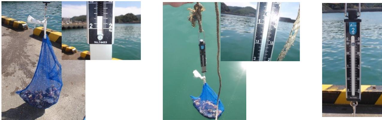
図 3-5-3 質量測定(左: 空中、中: 水中、右: 計測器)
