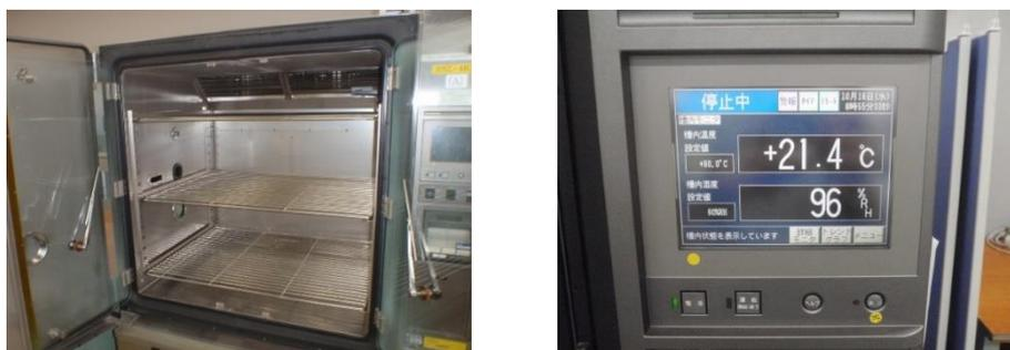
図 3-3-2 恒温恒湿槽（右：槽内状況、左：試験条件設定）
