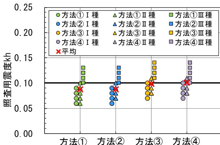
図-15 各方法のフィルターによる照査用震度の算定結果
