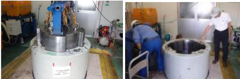
参図 3 高圧実験水槽 (左 : 密閉作業中、右 : 開放状態)
