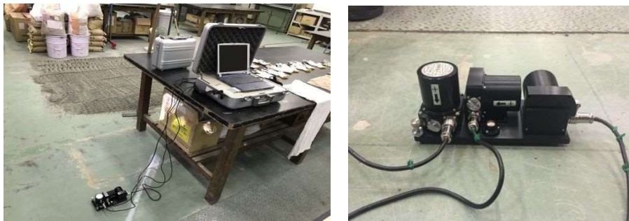
図 d-1-2-5 測定に用いた速度計と測定状況
