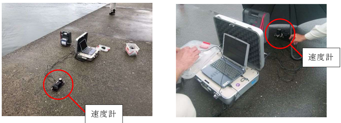
図 d-1-3-25 速度計計測状況（左：堤体計測状況、右：地盤計測状況）
