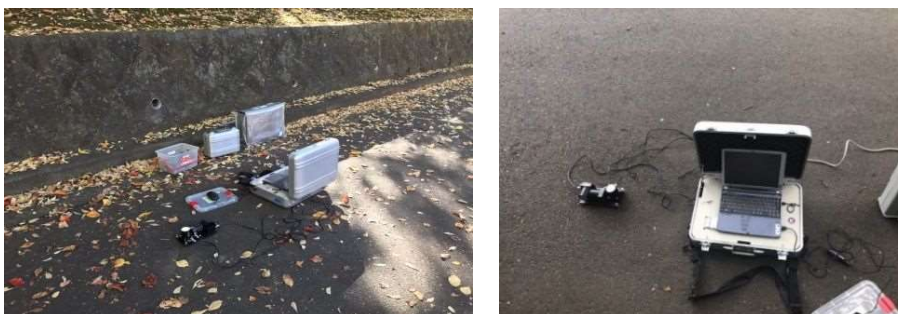
図 d-1-2-6 測定に用いた速度計と測定状況
