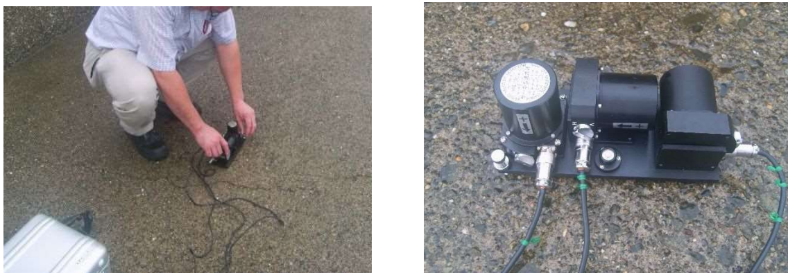
図 d-1-3-26 加速度計設置状況（左：水平調整状況、右：設置状況）
