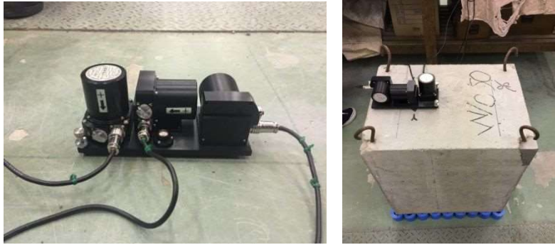
図 d-1-2-4 測定に用いた速度計（センサ）（左）と測定状況（右）
