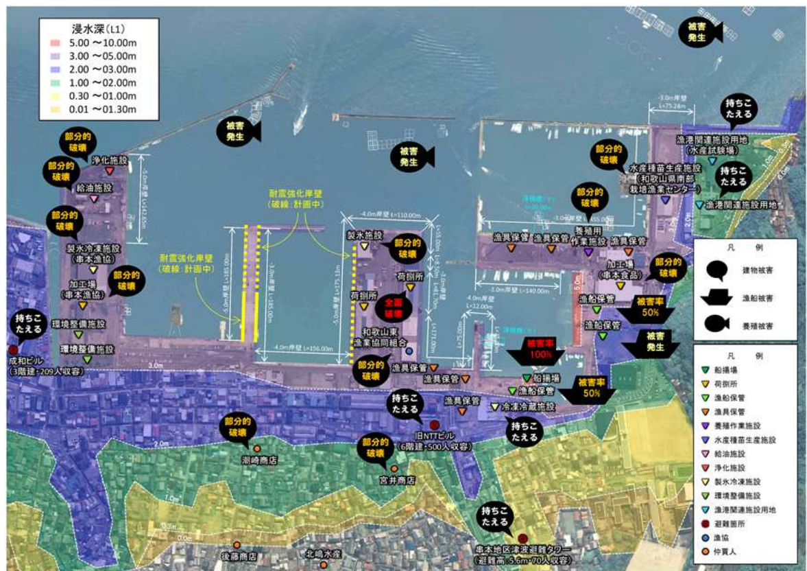
図(2)-2 想定される被害状況(復旧が必要な施設の把握、串本漁港)
