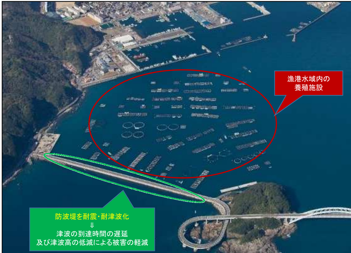
図（２）－ ６ 防波堤の耐津波化による効果の想定（串本漁港）
