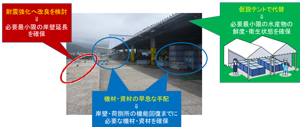
図（２）－５ 耐震強化岸壁への改良と周辺での対策事例
