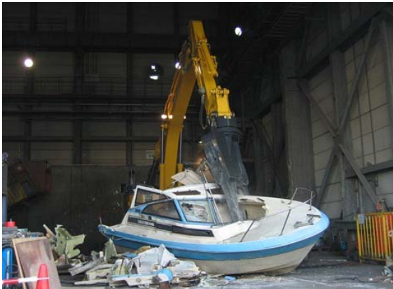
撤去後、重機により解体されるボート
