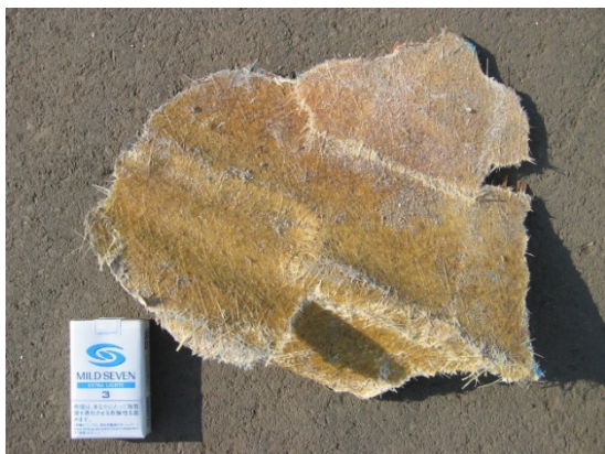
粗破碎されたFRPの断片
