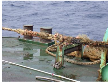
写真-6 回収された中層浮魚礁の状況（H26、沖縄県、剛体タイプ） （左：礁体浮上時、中：係留索の付着物、右：アンカー）
