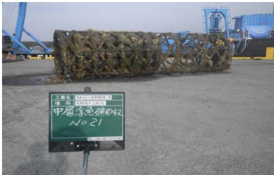
写真-7 回収された中層浮魚礁の状況（H27、鹿児島県、剛体タイプ） （右：礁体、右：上部主係留索の漁具絡み）
