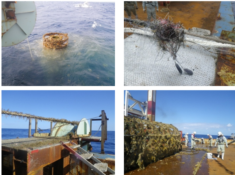
写真-2 回収された中層浮魚礁の状況（H25、沖縄県、剛体タイプ） （左上：礁体浮上時、右上：係留索の漁具絡み、 左下：下部主係留索の付着物、右下：回収された礁体）
