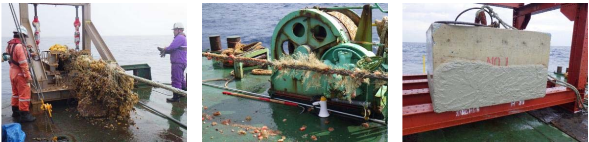
写真-5 回収された中層浮魚礁の状況（H26、沖縄県、柔体タイプ） （左：礁体の漁具絡みと付着生物、中：係留索の漁具絡み、右：アンカー）
