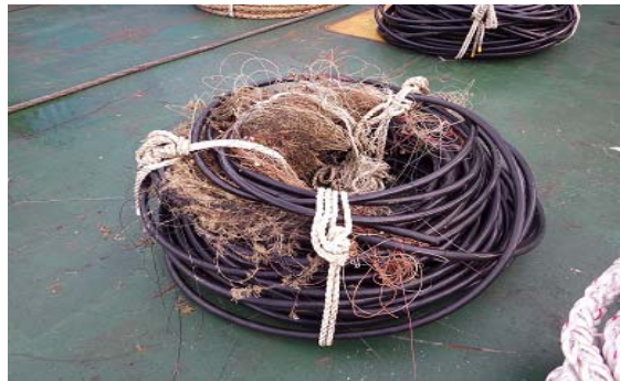
写真-7 回収された中層浮魚礁の状況（H27、鹿児島県、剛体タイプ） （右：礁体、右：上部主係留索の漁具絡み）
