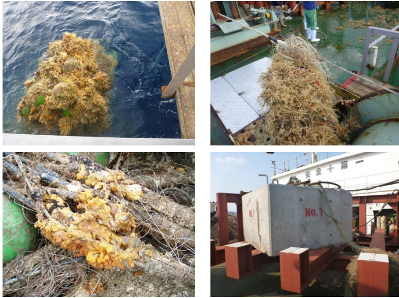
写真-1 回収された中層浮魚礁の状況（H25、沖縄県、柔体タイプ） （左上：礁体浮上時、右上・左下：係留索の漁具絡み）
