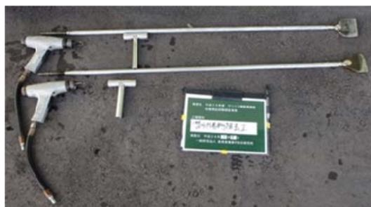
図VI.2.7 高圧空気駆動ケレンツール
