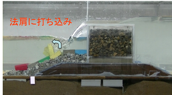
めくれによる被災例3(天端2個並)
