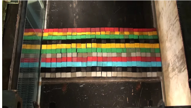
図 4.1.2 被覆材設置状況（防波堤なし）
