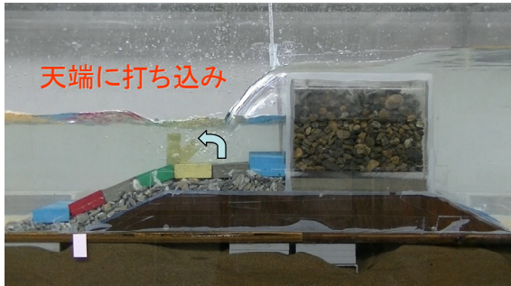
めくれによる被災例1(天端3個並)
