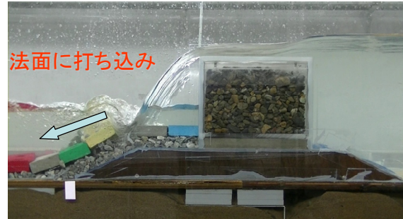
法面全体の滑りによる被災例(天端2個並)
