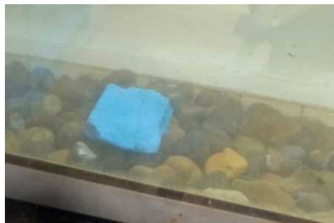
図 6-3 回流水槽の試験底面上に置かれた碎石の例
