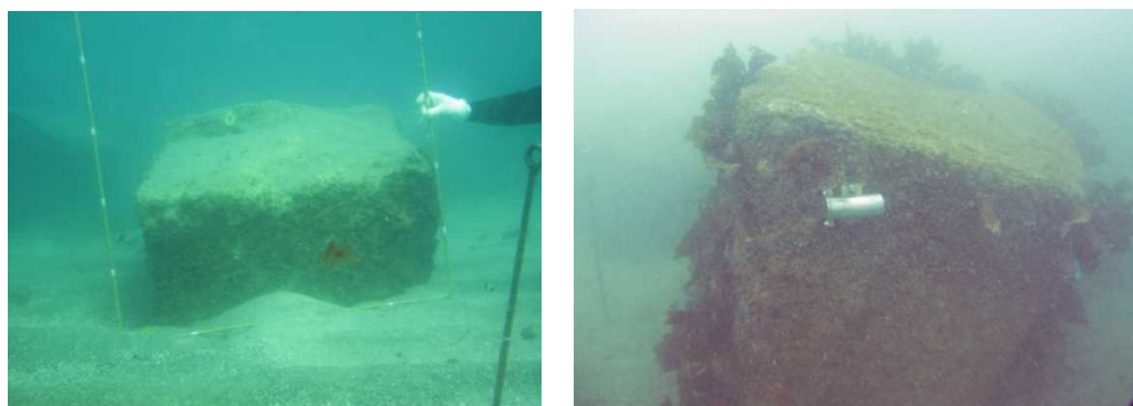
図 6-8 徳島県試験地の冠砂域に設置された割石(左)とそれに固定した加速度ロガー(右)。左写真の枠:1×1m
