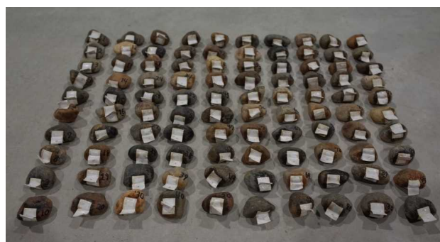
図 6-7 静止摩擦係数の測定に使用した、明田らが試験した玉石とほぼ同形同大の玉石（質量約 60g）
