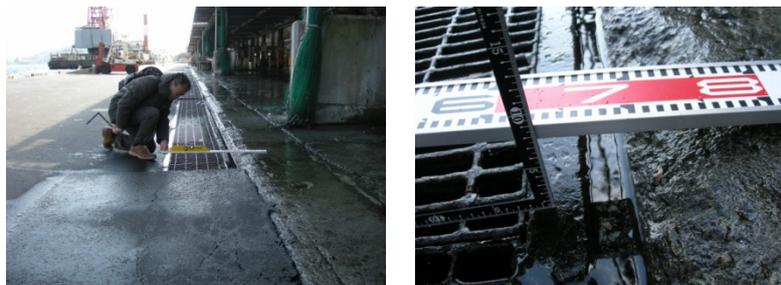
写真 4-7 「A4」漁港“現場 1”のすり付けの無い断面の段差の状況
