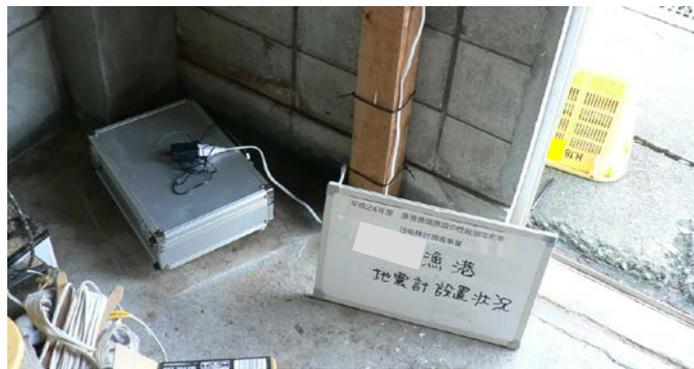
写真 5-2 地震計設置状況
