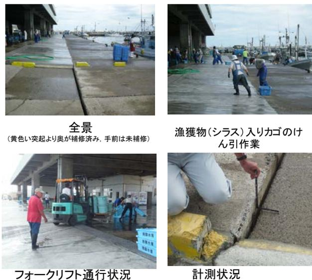
写真 4-27 補修されたエプロンにおける作業者等の通行状況（「A1」漁港。計測状況は未補修区間におけるもの）
