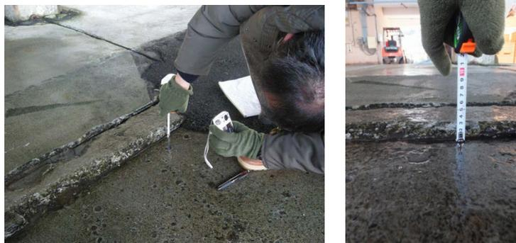
写真 4-11 「A4」 漁港 “現場 3” のすり付けの無い断面の段差の状況
