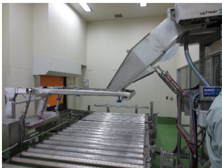
魚箱に蓋をする部分
