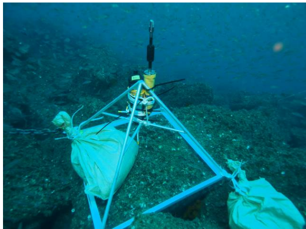
図 V-3-7 架台への電磁流速計の取り付け状況
