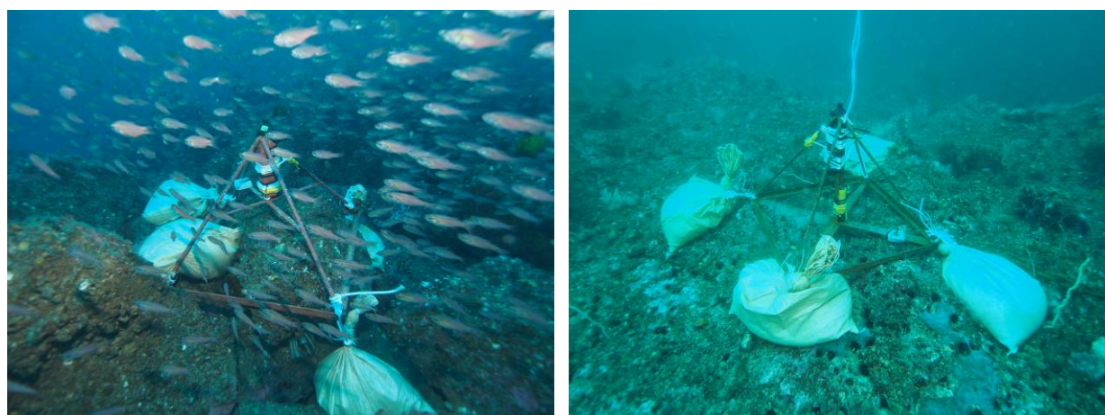
図 V－3－6 設置型受信機の設置状況（左：人工マウンド礁、右：天然礁）
