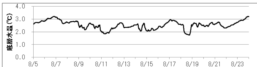
図3 海底水温(水深約200m)の経時変化(平成24年8月;折込根沖)
