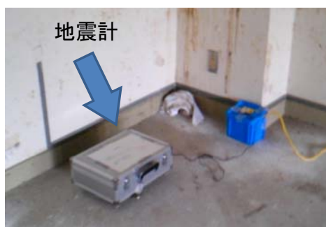
図 3 地震観測状況（女川漁港の荷さばき所事務室）
