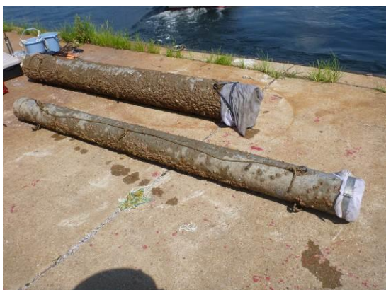
写真-3 回収した塩ビ管(法面) H23. 7
