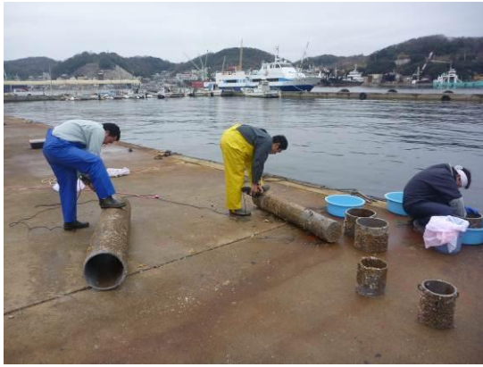
写真-9 塩ビ管切断・付着生物採取状況
