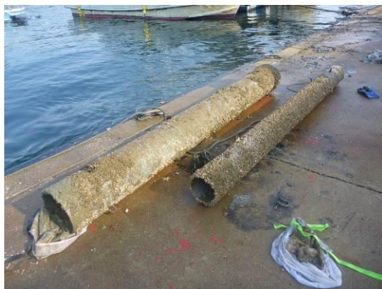
写真-8 回収した塩ビ管(法尻) H24. 1
