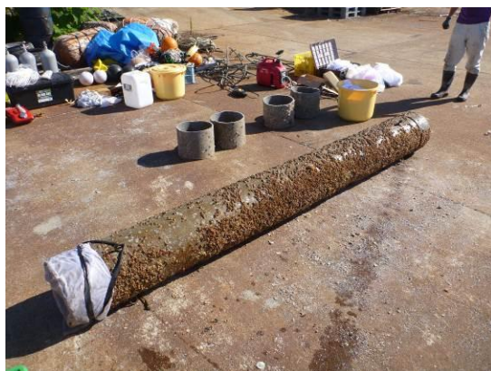
写真-4 回収した塩ビ管(法尻①) H23. 7
