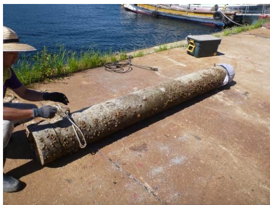
写真-2 回収した塩ビ管(天端②) H23. 7
