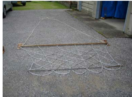
B チェーン曳き器具 (ダイヤモンド型, 幅 2.5m×長さ
