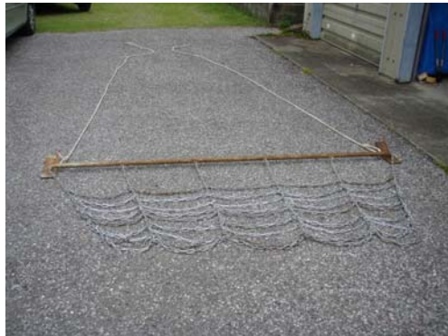
A チェーン曳き器具 (格子型, 幅 2.5m×長さ 1.8m) .
