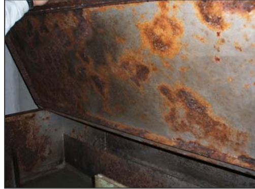
写真 - 3 水中ポンプ及び計量槽の発錆状況
