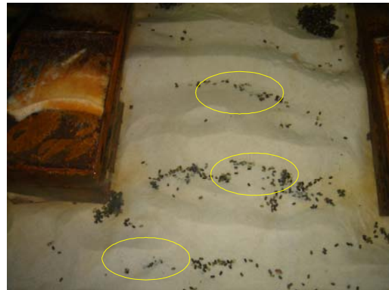
写真-3 模型開口部近影 (黄丸で示した部分で種子が埋没)
