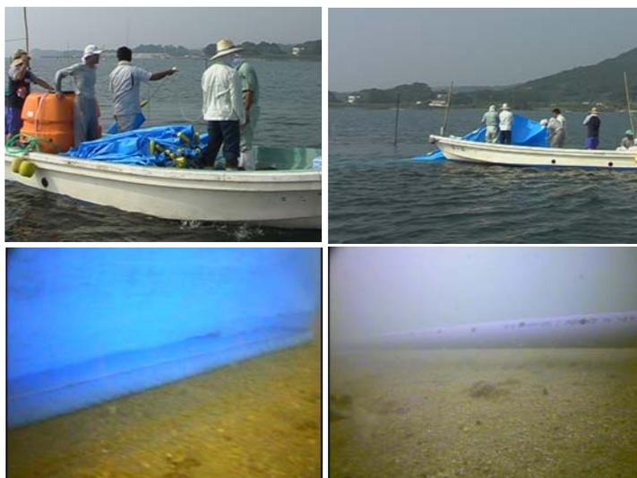
図 24 ブルーシート簡易膜設置と曝気海水導入試験の様子。（平成 17 年 9 月 2 日）
