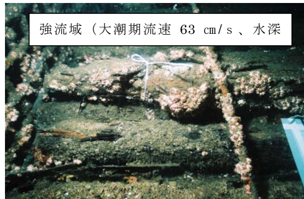
流速の異なる 2 地点における沈設 2 年後の腐朽状態
