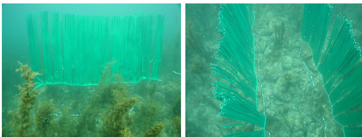
図8. 魚類の食害防除のための衝立状装置を水中に設置した状態. 左写真は正面から撮影、右写真は上から撮影.
