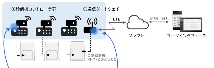
①給餌機コントローラ (各給餌機に設置) ②通信ゲートウェイ (隣接する漁場で1台)
