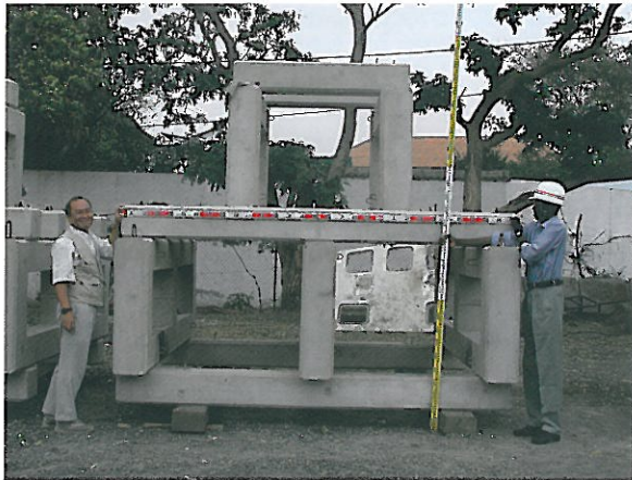
Figure 9 Bloc en béton (3 m x 3 m x 3 m)
