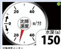
漁具の沈降速度を表示。メーター表示により、速度の変化を簡単に把握可能。
