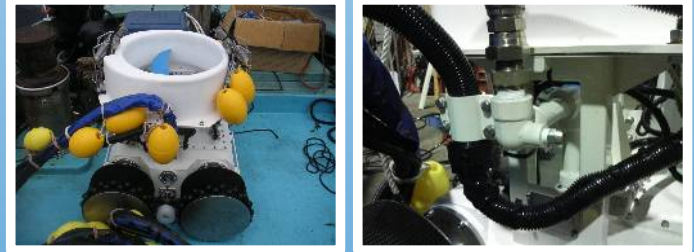
(写真) 高圧ホース取付位置変更後
