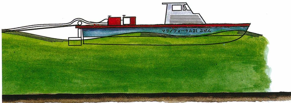
平成2年より3ケ年で大分県豊前海干潟域においてハマグリ増殖の実証事業を行い、その一環として耕耘ロボットシステムを開発した。漁場耕耘は底質の浮泥の除去、還元層の酸化、外敵生物の駆除などに効果があることが知られている。本実証事業において、実機を製作し、効果確認のための増殖場耕耘実験を行なった。その結果、アサリやハマグリなどの砂泥域有用二枚貝類の生息環境を改善し増殖を促す効果があることが確認された。
