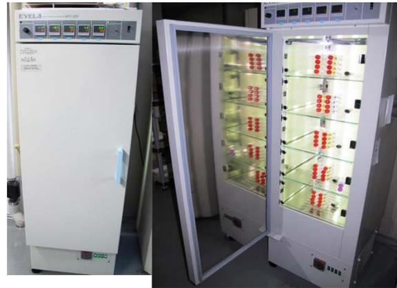
図 2-イ-1. 多段培養庫内(EYELA 社製 MTI-201)を用いた培養実験の様子
