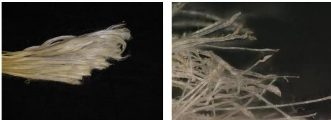
写真 3-2-14 切断面が不揃いのストランド（左：ストランド、右：拡大）
