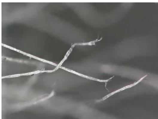
写真 3-2-17 引張荷重により破断した係留索と同材料
