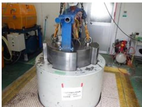
高压実験水槽（密閉作業中）
