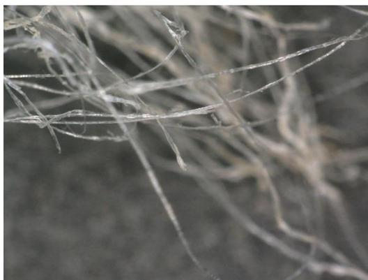
写真 3-2-15 エッジにて摩耗切断させた係留索と同材料のヤーン
