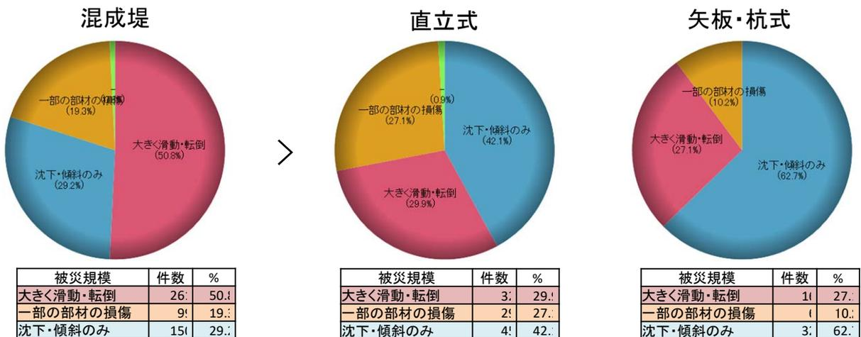
図 4-2-3 防波堤の構造形式ごとの被災規模
