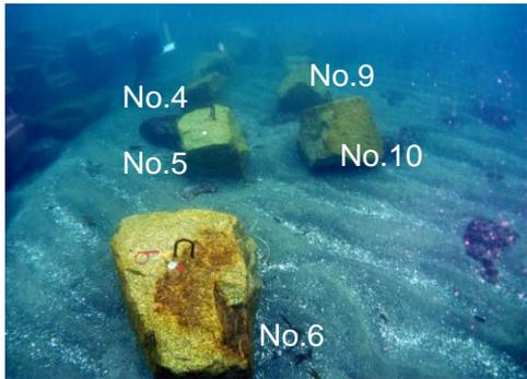
2~3tクラス (1.16~3.01t ;  $M_{50}=2.04t$ ) の割石10個を設置。設置時の割石 (吊り下げ金具は上側)
