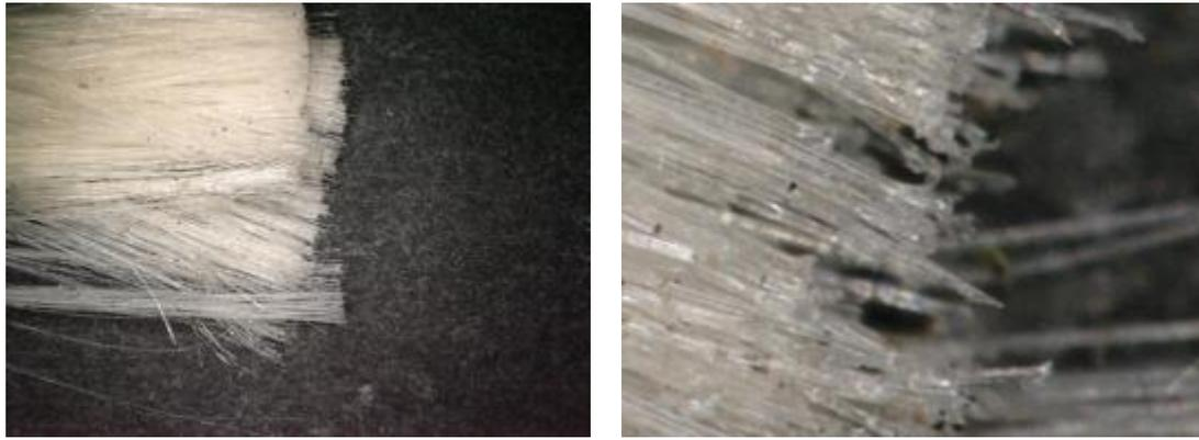
写真 3-2-16 ナイフにて切断させた係留索と同材料
