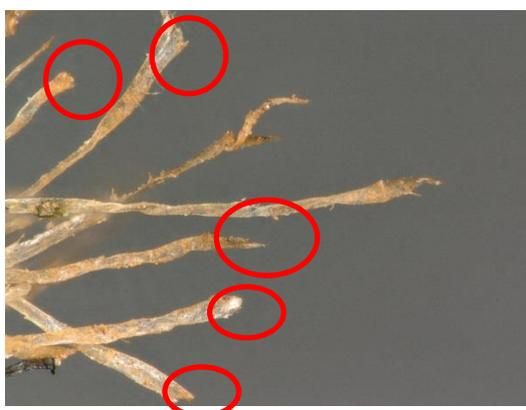
写真 3-2-13 切断面が揃っているストランド (左：ストランド、右：拡大)
