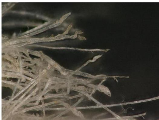
写真 3-2-14 切断面が不揃いのストランド (左：ストランド、右：拡大)
