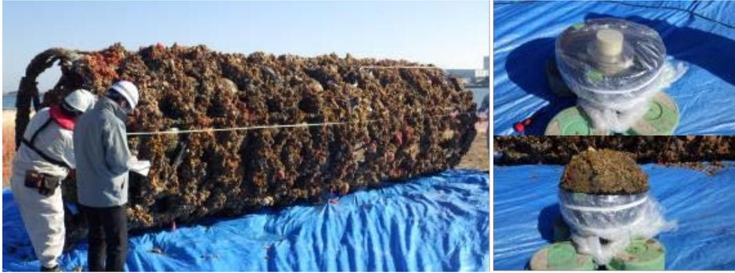
試験状況(左：回収された中層浮魚礁、右上：流出警報発信機、右下：付着物付試験機)
