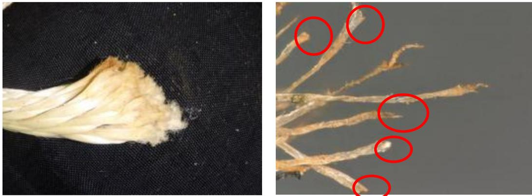
写真 3-2-13 切断面が揃っているストランド（左：ストランド、右：拡大）
