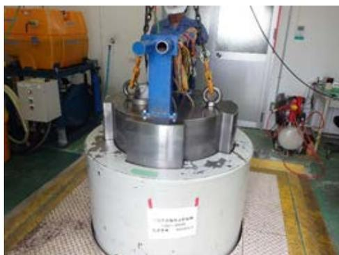
高圧実験水槽（密閉作業中）
