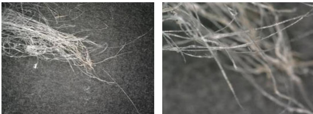
写真 3-2-15 エッジにて摩耗切断させた係留索と同材料のヤーン
