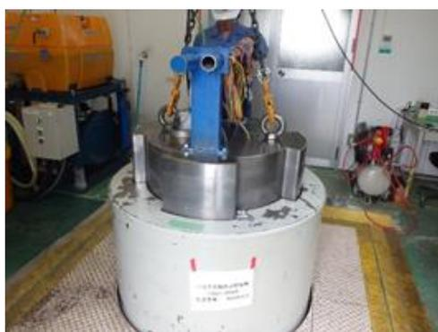
高圧実験水槽（密閉作業中）
