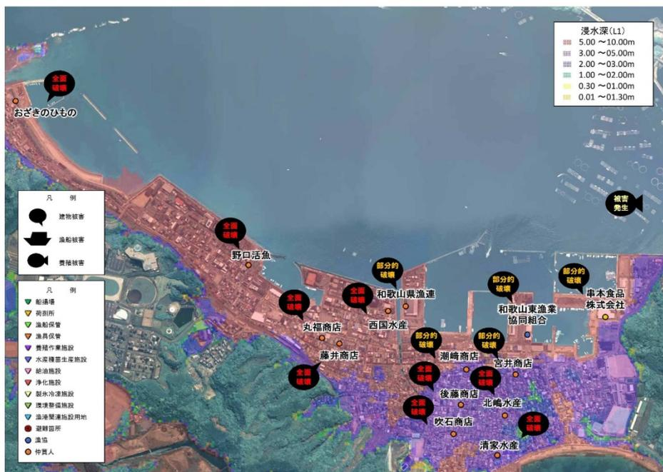
図- 2.10 L2津波による施設の被害想定(広域)
