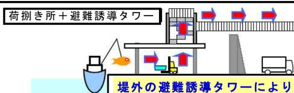
堤外の避難誘導タワーにより高さを確保し、堤内へアクセス
