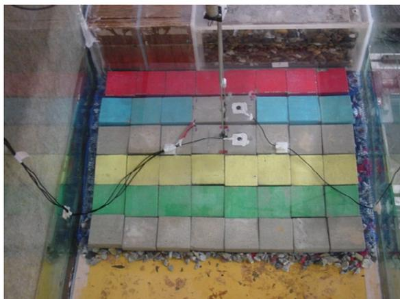
図 2.5.6 圧力計設置状況(天端2個並)
