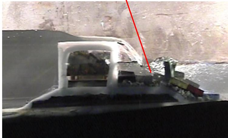
図 2.3.3 被覆材被災状況 (腹付け有り (1/4)、天端被覆材 3 個)
