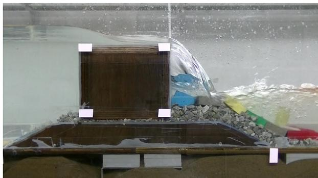
図 2.1.2 防波堤模型
