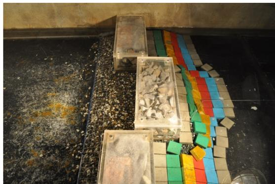
図 2.2.2 引張試験 堤体滑動状況（水中・腹付け有り）
