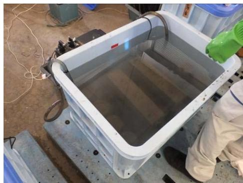
図1-2-7 2ヶ月後の硫酸マグネシウム飽和溶液中の状況
