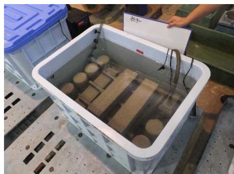
図1-3-10 1年後の硫酸マグネシウム飽和溶液中の状況
