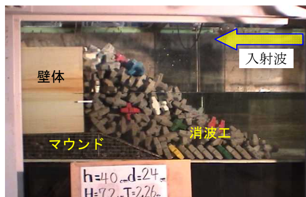
図 2. 1. 1 防波堤の実験模型（消波工有り）
