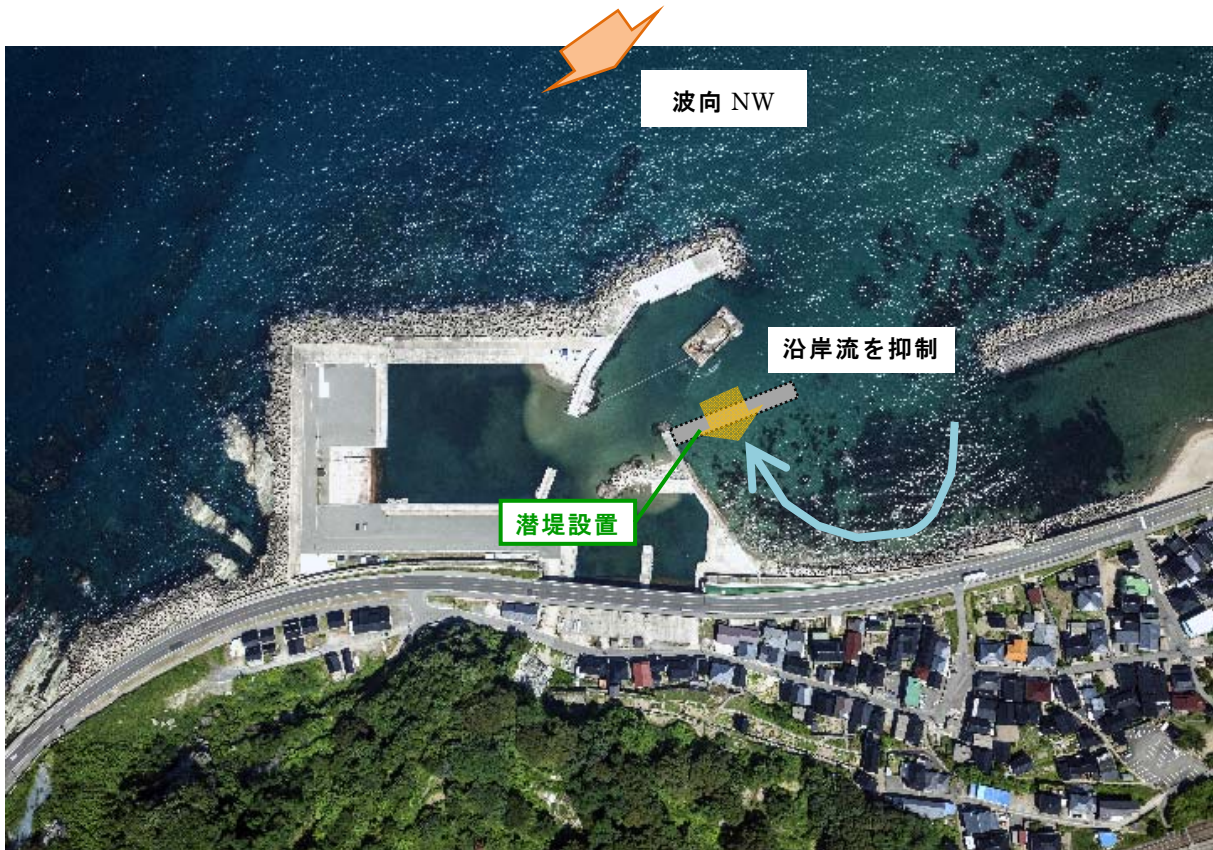
図-5.28 対策港形案:小波渡漁港 潜堤設置 (延長 70m)
