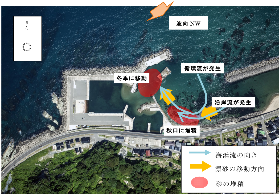
図-5.26 小波渡漁港における航路・泊地の埋没機構
