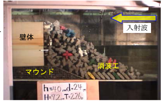
写真 2 消波工設置状況
