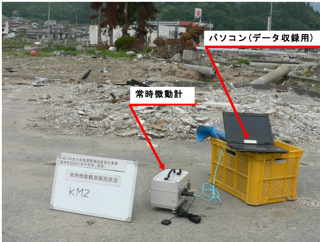
写真 - 2.4.2.3.1 常時微動観測状況
