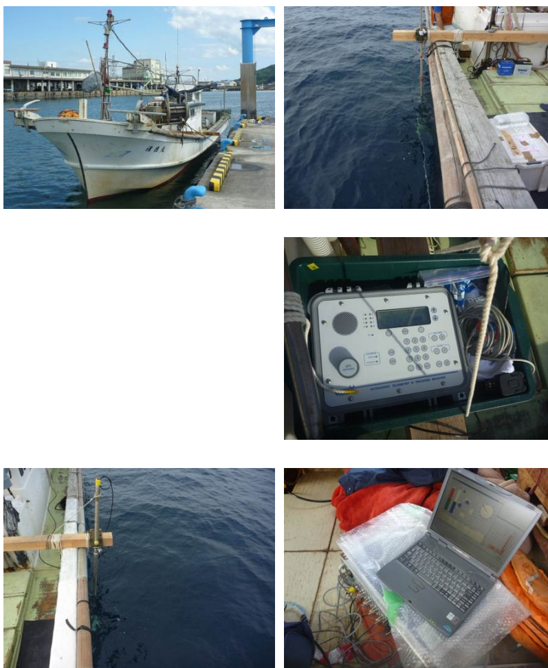
写真4 調査船（左上）、VR100 受信部（中上）、VR100 受信機本体（右上）、VR28 受信部（中下）、VR28 受信機本体（右下）
