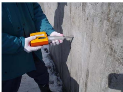
シュミットハンマーによる本体強度測定
