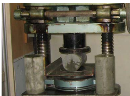
割裂引張試験
