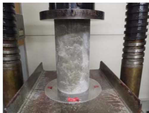
テストピース圧縮強度試験
