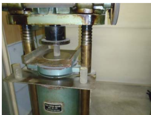
モルタルテストピース圧縮強度試験
