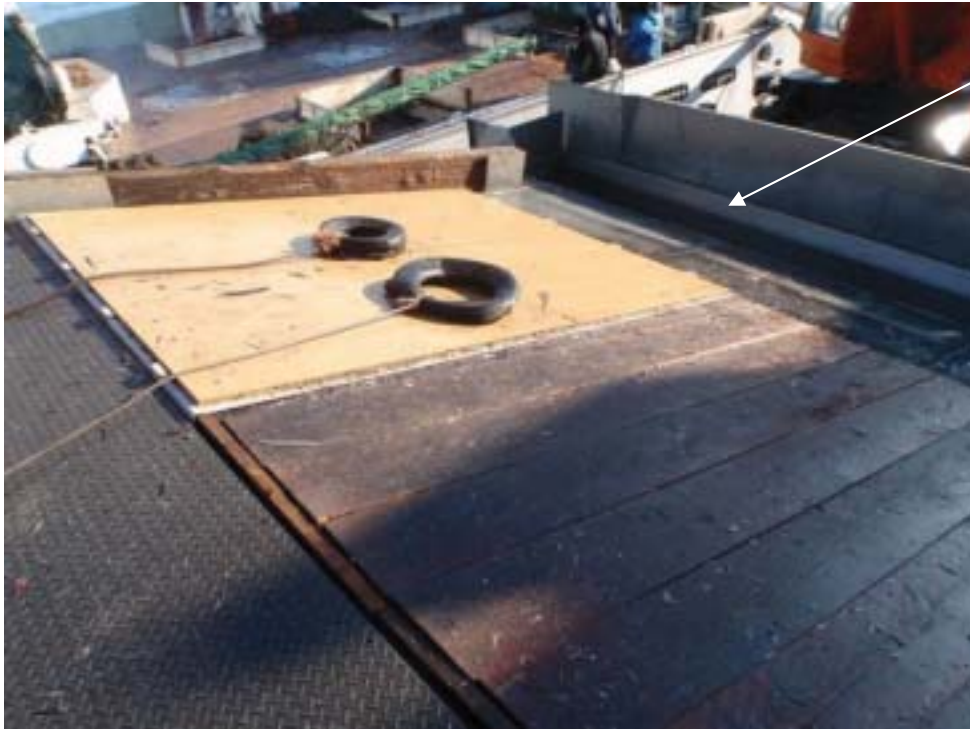
写真 2-4 タイヤ設置後の実験用落とし台
