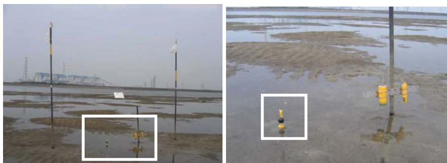
図 V-4-3 干潟上への観測器の設置。右図白枠内が自記式電磁流向流速計
