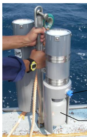
図 VI-3.1 セジメントトラップ（2 筒型）の例
