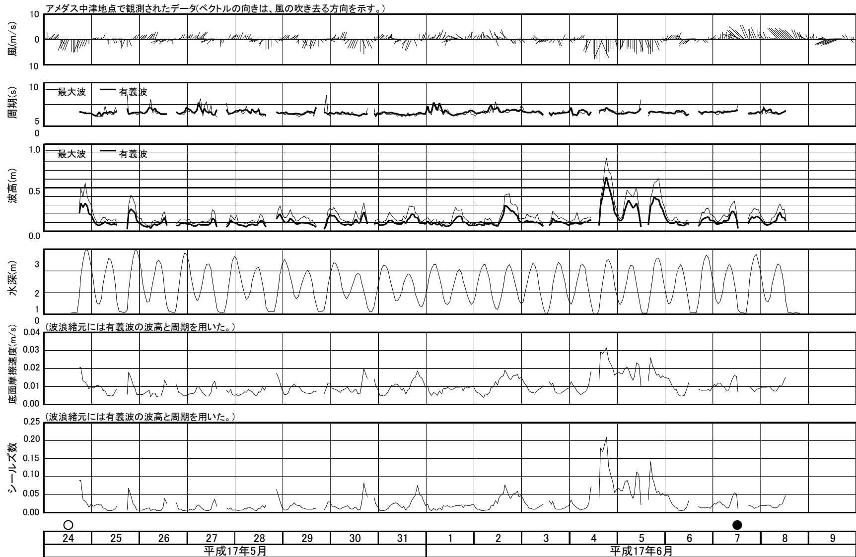
図10 シールズ数算定結果とアメダス中津地点での風データ
