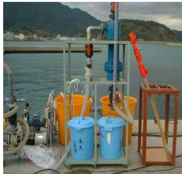
図 4-5 汚泥分離装置の外観写真
